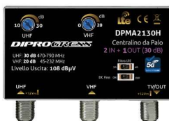
DPMA2130H 2 Ingressi (1 VHF + 1 UHF) 1 Uscita, + 30dB, out 108dBuV
