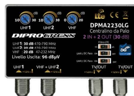
DPMA2230LG 2 Ingressi (1 Log + 1 UHF) 2 Uscite, + 30dB, out 96dBuV
