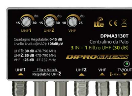
DPMA3130T 3 Ingressi (1 VHF + 2 UHF) 1 Uscita, + 30dB, out 108dBuV
