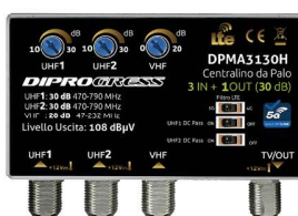
DPMA3130H 3 Ingressi (1 VHF + 2 UHF) 1 Uscita, + 30dB, out 108dBuV
